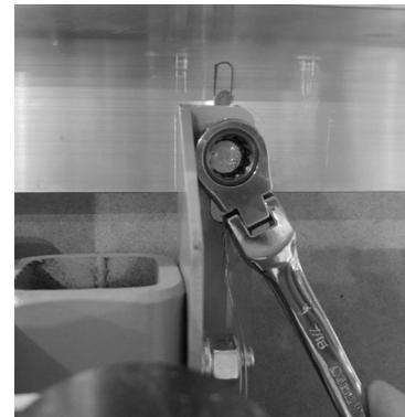
▲ ENSURE EACH HEX BOLT ON EACH SIDE IS FIRMLY TIGHTENED
